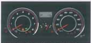
●オプティロンコンビネーションメーター(スポーツタイプ/照度コントロール&ドライブモニター付)
