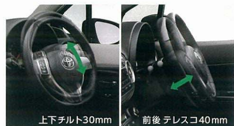
上下チルト30mm 前後 テレスコ40mm
