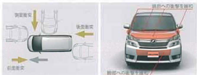
全方位コンパティビリティのイメージ 歩行者傷害軽減ボディ構造
