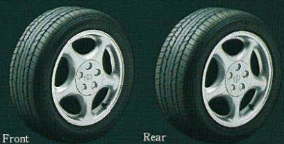
フロント225/50 ZR16・リヤ245/45 ZR16 スチールラジアルタイヤ&アルミホイール [RZ-S, SZ-Rに標準。SZはフロント、リヤとも225/50 R16 92Vとなります。]
