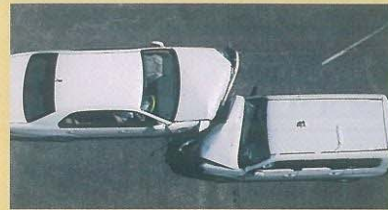
Car to Car 50%ラップオフセット前面衝突試験(双方50km/h、実験用試作車)
