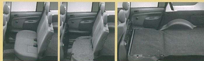
シートバック一体可倒クッション引き起こし式リヤシート
