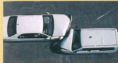
Car to Car 50%ラップオフセット前面衝突試験(双方50km/h、実験用試作車)
