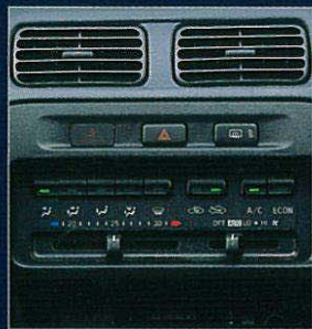
クリーンエアフィルター付オートエアコン & プッシュ式ヒーターコントロールパネル
