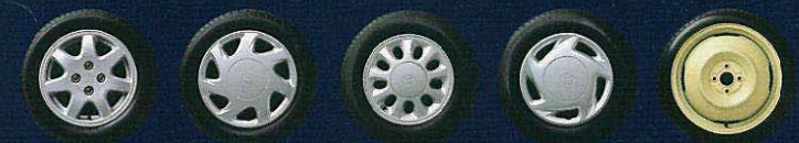
185/55R14 79V 5.5J アルミホイール 185/55R14 79V 5.5J フルキャップ 165/70R13 79S 5J アルミホイール 165/70R13 79S 5J フルキャップ スペアタイヤ (応急用タイヤ)
