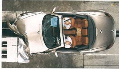
オフセット前面衝突実験 (64km/h、写真は実験用の試作車<米国土仕様>です)
