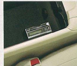
有料道路自動料金支払いシステム“ETC”ユニット ※写真は取付イメージです。車種により取付位置は異なります。
