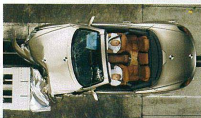
オフセット前面衝突実験 (64km/h、写真は実験用の試作車<米国仕様>です)
