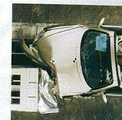
オフセット前面衝突実験 (64km/h、写真は実験用の試作車)
