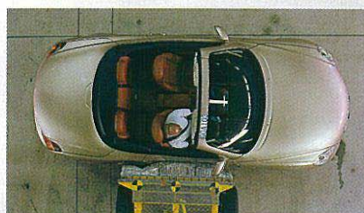
側面衝突実験 (55km/h、写真は実験用の試作車です)
