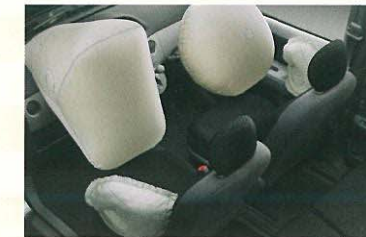
SRSエアバッグ&SRSサイドエアバッグ(運転席・助手席) ●写真は機能説明のためにSRSエアバッグが作動した状態を再現したものです。なお、SRSサイドエアバッグは、実際の衝突時には衝突前のみ膨らみます。
