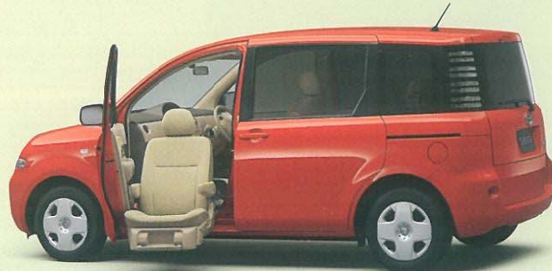
Photo:シエンタ 1.5G (2WD) 助手席リフトアップシート車 “Aタイプ”。ボディカラーはスーパーレッドV (3P0)。ディスプレイヘッドランプはメーカーオプション。
