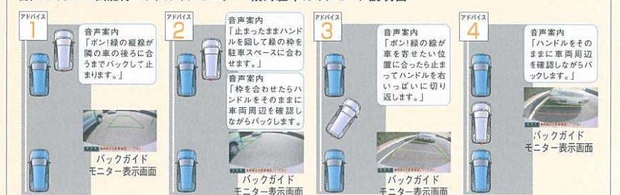
音声ガイダンス機能付バックガイドモニター 縦列駐車ガイドモード説明図
