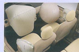
デュアルSRSエアバッグ&SRSサイドエアバッグ(運転席・助手席) ■写真は機能説明のためにSRSエアバッグが作動した状態を再現したものです。なお、SRSサイドエアバッグは、実際の衝突時には衝突側のみ膨らみます。
