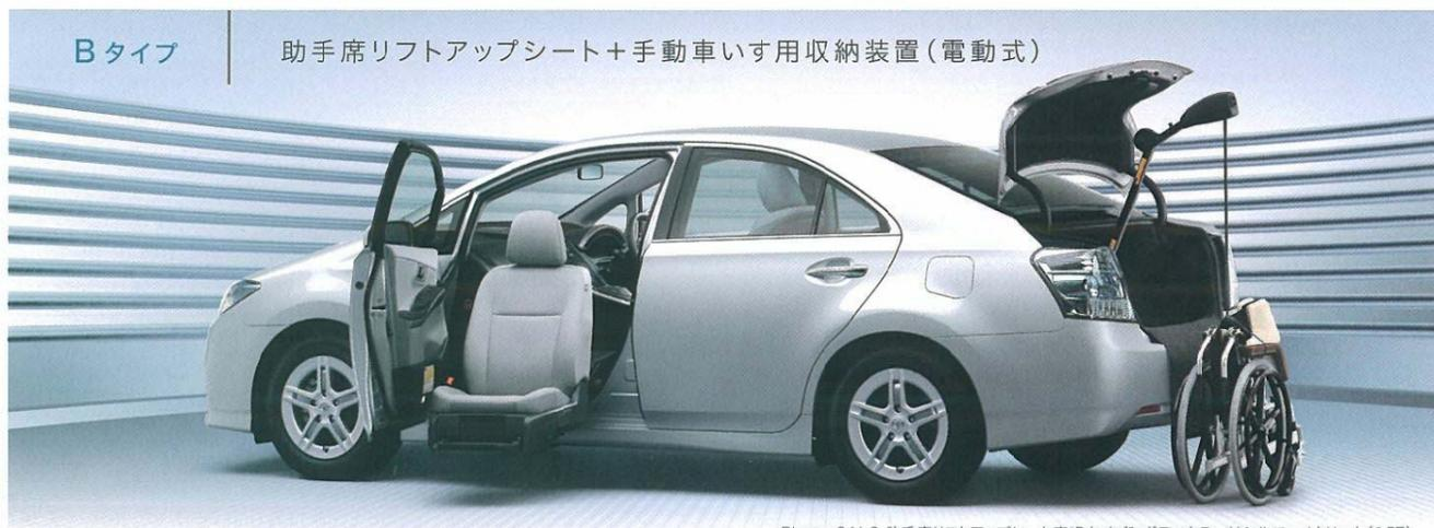
Bタイプ 助手席リフトアップシート+手動車いす用収納装置(電動式)
