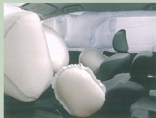
SRSエアバッグ/SRSサイドエアバッグ(運転席・助手席)&SRSカーテン シールドエアバッグ(前後席)
