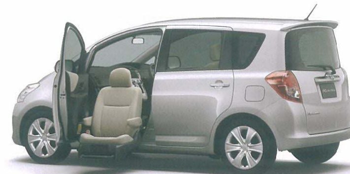
Photo: ラクティス 1.5G (2WD) 助手席リフトアップシート車 "Aタイプ"。 ボディカラーはシルバーマイカメタリック (1E7)。
