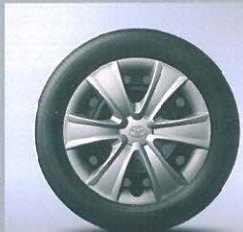
175/60R16 82Hタイヤ& 16×5 1/2Jスチールホイール(樹脂フルキャップ)
