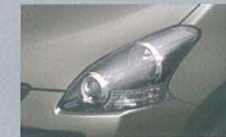
プロジェクター式ハロゲンヘッド ランプ(マニュアルレベリング 機能付/スモーク)
