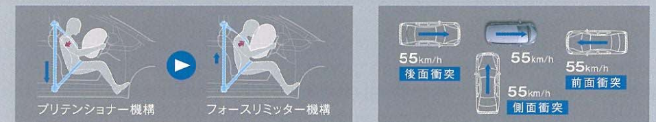
プリテンショナー & フォースリミッター機構付シートベルト
