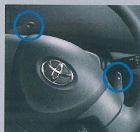
パドルシフト ※シフトレバーがMポジション時に作動します。
