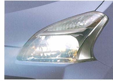
ディスチャージヘッドランプ(オートレベリング機能付)
