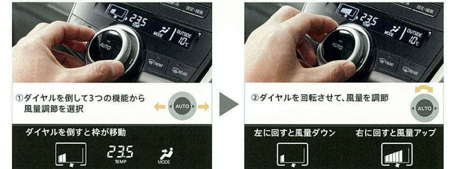
[調節できる3つの機能] 風量調節 (7段階) 設定温度切替 (0.5°C毎) 吹き出し口切替 (4モード)
