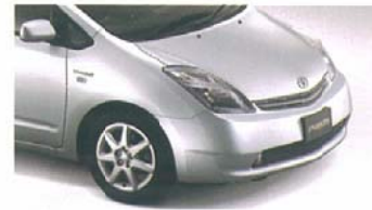
【歩行者傷害軽減に配慮したボディ構造】
