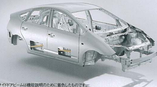
■サイドアビームは機能説明のために着色したものです。
