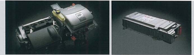
プリウス専用パワーユニット (エンジン、トランスミッション、インバータ)
