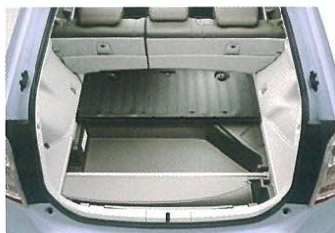
トノカバー収納時 デッキボード下のデッキアンダートレイに トノカバーを収納できます。 [Lグレードを除く]
