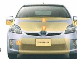
A 衝撃吸収バンパー構造 C 衝撃吸収フェンダーブラケット構造 B 衝撃吸収フード構造 D 衝撃吸収カウル構造
