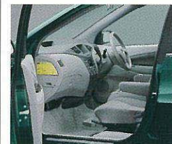
シートロック解除レバーを手前に引いてロックを解除します。[手動]
