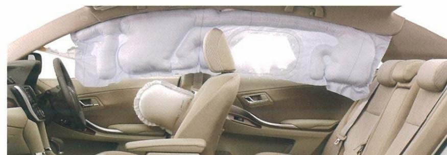
SRSサイドエアバッグ&SRSカーテンシールドエアバッグ
