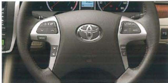
ステアリングスイッチ (メーカーオプションのHDDナビゲーションシステム装着車)
