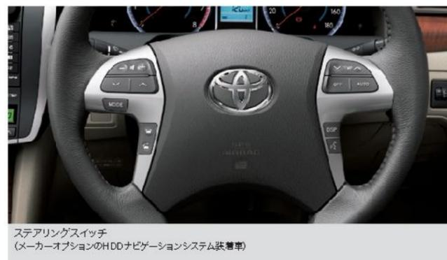
ステアリングスイッチ(メーカーオプションのHDDナビゲーションシステム装着車)
