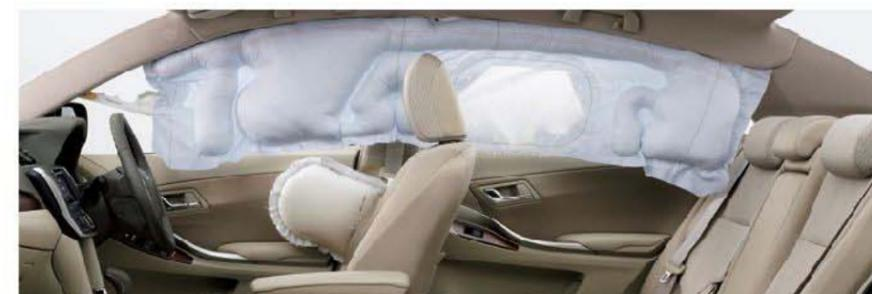
SRSサイドエアバッグ&SRSカーテンシールドエアバッグ
