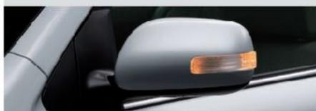
サイドターンランプ付電動格納式リモコンカラードドアミラー
