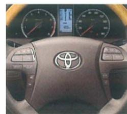
ステアリングスイッチ(メーカーオプションのHDDナビゲーションシステム装着車)
