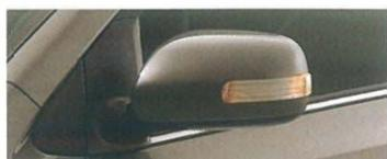
サイドターンランプ付電動格納式リモコンカラードアミラー
