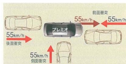
全方位コンパティビリティボディ構造イメージ(同クラスの車両衝突)
