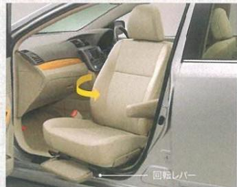
2 回転レバーを事前に引いて、シートを回転させます。(シートがロックするまで、回転させてください)
