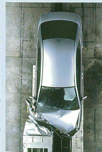
オフセット前面衝突実験 (64km/h、写真は実験用の試作車)
