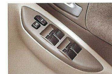
パワーウィンドウ (運転席ワンタッチ式・挟み込み防止機構付) & ドアキー連動電気式ドアロック
