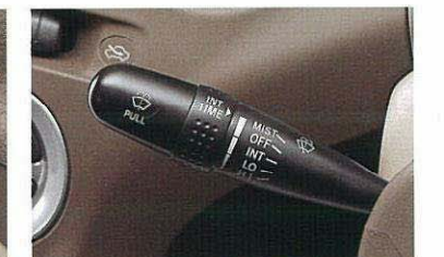
ウォッシャー連動時間調整式 間欠フロントワイパー (ミスト機構付)
