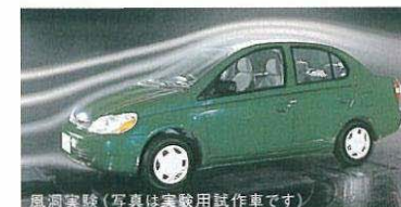
風洞実験（写真は実験用試作車です）
