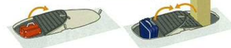
●写真、イラストは2WD(78L)、4WD(49L)はボックス形状が異なります。(VDA方式測定値) ●ラゲージリッド(3ウェイ)はYY以外に設置。
