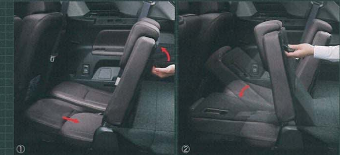
① サードシート格納操作 ① シートバックのレバーを軽く引くと自動的にクッションが格納。② シートバックを前に倒す。
