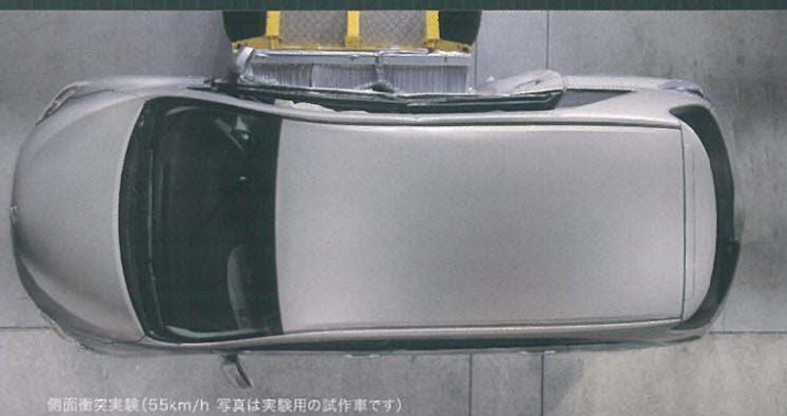
側面衝突実験(55km/h 写真は実験用の試作車です)
