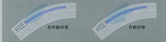
低速時の可動角度(車速10~30km/h) ●右コーナリ場合:右側のみ最大20度 ●左コーナリ場合:左側のみ最大10度 中速時の可動角度(車速30km/h以上) ●右コーナリ場合:右側最大15度+左側最大7.5度 ●左コーナリ場合:右側最大5度+左側最大10度
