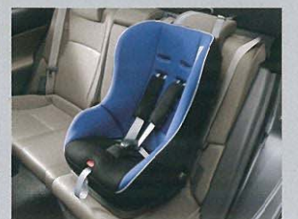
ISOFIX対応チャイルドシート固定専用バー+ トップテザーアンカー
