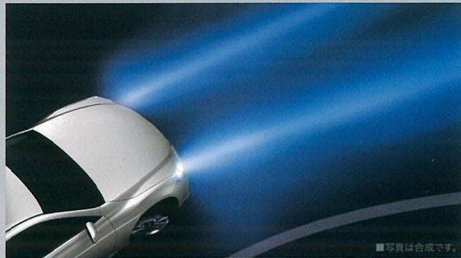
■インテリジェントAFS機能イメージ(右コーナリング・中速時)
