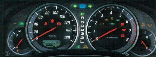
① オブテイトロンメーター(メーター照度コントロール付) 視認性に優れた自発光式アナログメーター。 立体造形された金属調の表示パネルに、 イグニッションキーONで文字やウォーニングが 浮かび上がります。 ■計器盤の写真は機能説明のために各ランプを 点灯したものです。実際の走行状態を示すものではありません。
