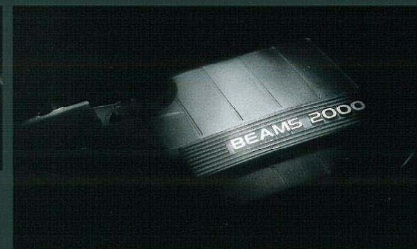
BEAMS 1G-FE VVT-i 総排気量: 1,988ℓ 最高出力: [ネット] 118kW (160PS) / 6,200 r.p.m. 最大トルク: [ネット] 200N·m (20.4kg·m) / 4,400 r.p.m.
