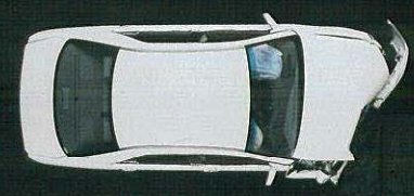
オフセット前面衝突実験 ■64km/h、写真は実験用の試作車
