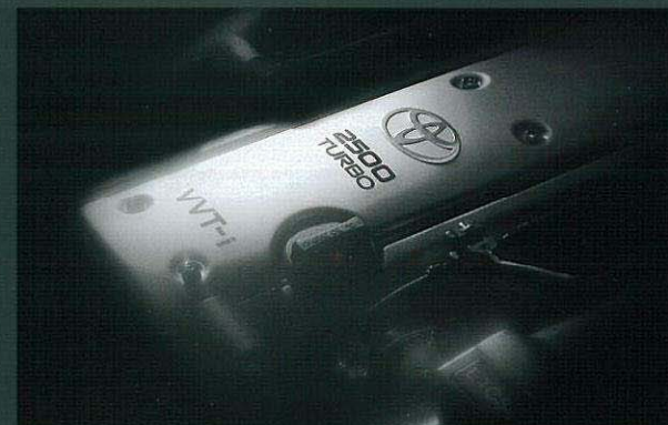
BEAMS 1JZ-GTE VVT-i 総排気量: 2,491ℓ 最高出力: [ネット] 206kW (280PS) / 6,200 r.p.m. 最大トルク: [ネット] 378N·m (38.5kg·m) / 2,400 r.p.m.
