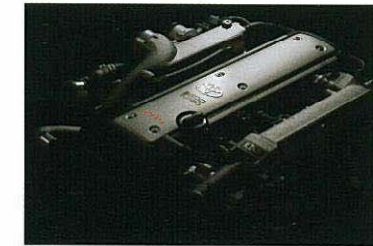
総排気量:2.491ℓ 最高出力(ネット):280PS/6,200r.p.m. 最大トルク(ネット):38.5kg-m/2,400r.p.m. 燃料消費率(10・15モード):9.6km/ℓ ※オートマチック車。
