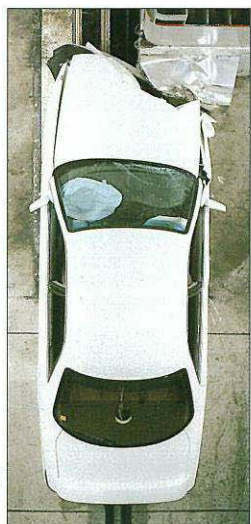
オフセット前面衝突実験 (60km/h) ※写真は実験用試作車です。
