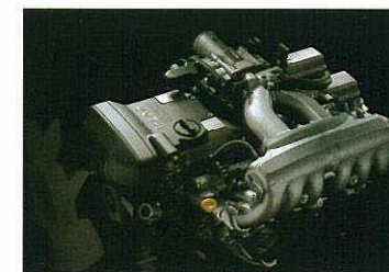
総排気量:2.997ℓ 最高出力(ネット):220PS/5,600r.p.m. 最大トルク(ネット):30.0kg-m/4,000r.p.m. 燃料消費率(10・15モード):10.0km/ℓ
