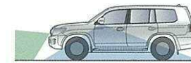
カメラ視野のイメージ図 ■ フロントカメラによる視野範囲 ■ サイドカメラによる視野範囲
