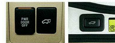
メインスイッチ+オープン&クローズスイッチ(運転席) クローズスイッチ(バックドア)
