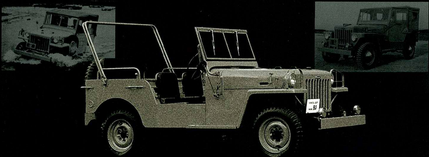
1951年 初代 BJ型トヨタジープ 直列6気筒OHVエンジンを搭載した本格4WDとして誕生
