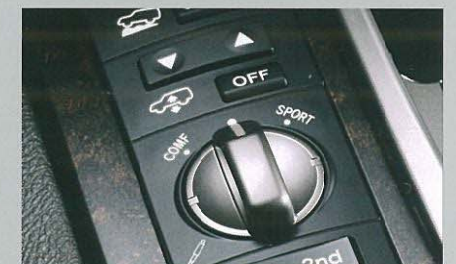
4-Wheel AHC & AVS(4輪アクティブ・ハイト・コントロール・サスペンション&アダプティブ・バリアブル・サスペンション・システム)
