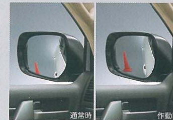
電動格納式カラードアミラー (リバース連動下向き)
