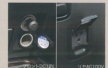
アクセサリースOCKET&コンセント *AC100Vは、100W以下の電気製品をご使用ください。 ただし、100W以下の電気製品でも正常に作動しない場合 がありますので、詳しくは販売店におたずねください。
