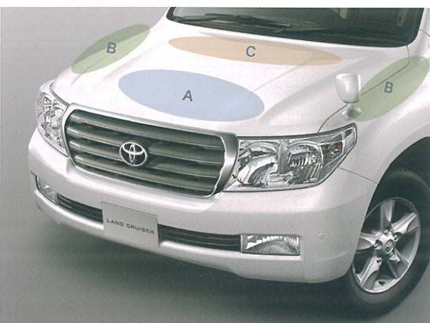
歩行者傷害軽減ボディ構造 A:フード部 B:フェンダー部 C:カウル部
