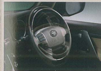
電動チルト&テレスコピクスティング 【AX"Gセレクション"に標準装備】
