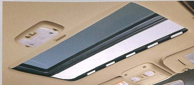
チルト&スライド電動式ムーンルーフ (挟み込み防止機能付)
