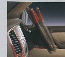
電動チルト&テレスコピックステアリング (メーカーオプション)
