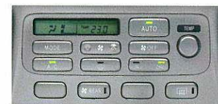
デジタルプッシュ式ヒーターコントロールパネル ※EMV非装着時(ワゴン)
