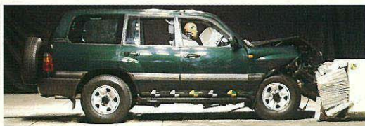
オフセット前面衝突実験 (60km/h、写真は実験用の試作車です。)
