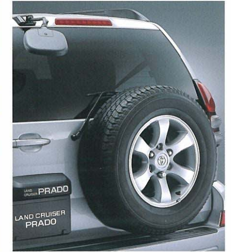
バックドア付スペアタイヤキャリア(ロック付)&リヤアンダーミラー
