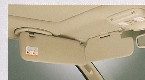
スライド式ダブルサンバイザー (運転席・助手席) / チケットホルダー付 (運転席)
