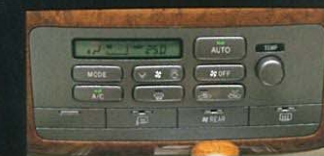
デジタルプッシュ式ヒーターコントロールパネル ※EMV非装着時
