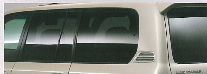
UVカット機能付プライバシーガラス (リヤドア、リヤクォーター、バックドア)
