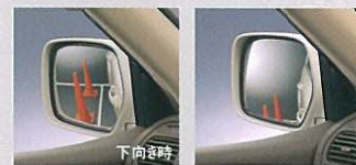
リバース連動下向きアミラー(自動防眩式) [運転席・助手席]
