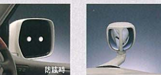
リバース連動下向きアミラー(自動防眩式) [運転席・助手席]
