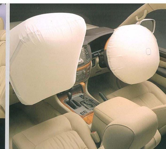
デュアルステージSRSエアバッグ(運転席・助手席)
