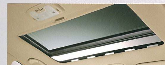
マイコン制御チルト&スライド電動式ムーンルーフ (挟み込み防止機能+ドアキー連動機能付)
