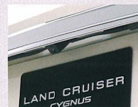
カラーバックガイドモニターカメラ部 (バックドアガーニッシュ下部)
