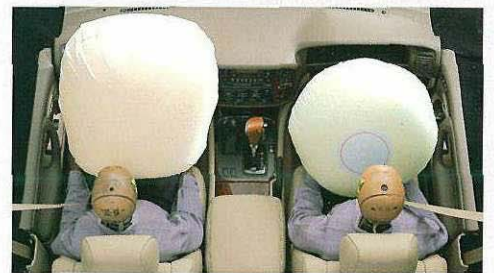
●オフセット前面衝突実験 (60km/h) ■写真は実験用の試作車です
