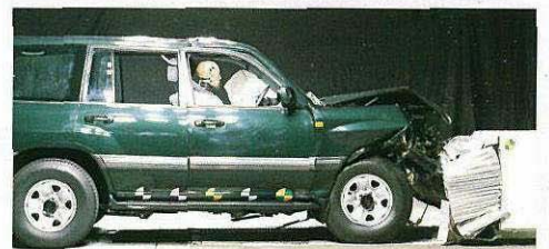
●オフセット前面衝突実験 (60km/h) ■写真は実験用の試作車です
