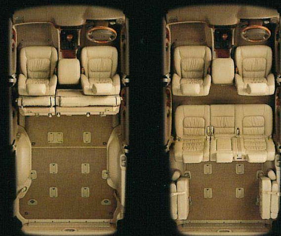
セカンドシート、折たたみ状態 & デイッチャブルサードシート取り出し状態 サードシートベースアップ状態
