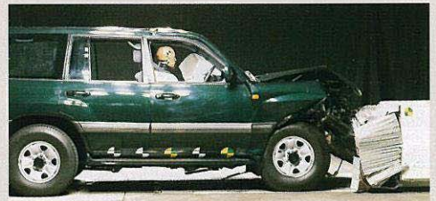
●オフセット前面衝突実験(60km/h) ■写真は実験用の試作車です。
