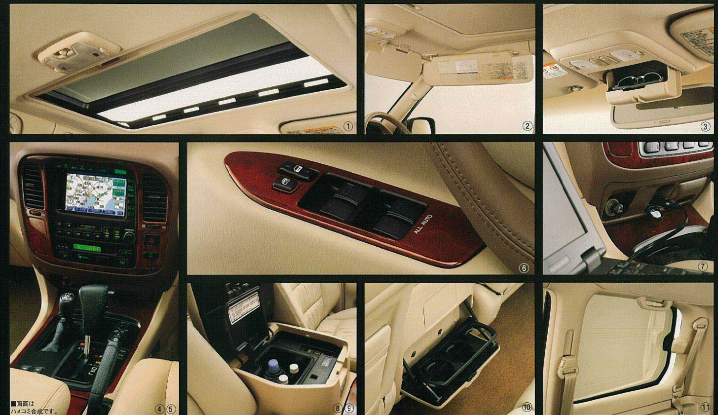
INTERIOR ①チルト&スライド電動式ムーンルーフ ②スライド式ダブルサンバイザー（運転席・助手席）③オーバーヘッドコンソール（小型）④本木目センタークラスターパネル ⑤本木目フロントコンソールパネル ⑥本木目パワーウィンドウスイッチベース ⑦アクセサリソケット（DC12V） ⑧クールボックス（メーカーオプション）⑨マルチCDオートチェンジャー（GPSボイスナビゲーション付EMV、ランドクルーザー・スーパーライブサウンドシステム＜EMV仕様＞、TV/FMダイバーシティガラスアンテナとセットでメーカーオプション） ⑩カップホルダー（後席用） ⑪パワークォーターウィンドウ
