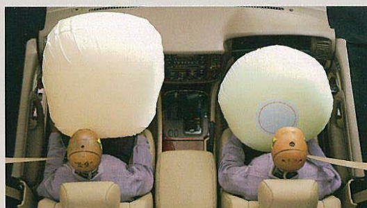
●デュアルSRSエアバッグ ■写真は機能説明のためにSRSエアバッグが作動した状態を再現したものです。 *チャイルドシートなどを助手席に装着するときは、後向きにしないなど、ご注意ください。必ず取扱書をご覧ください。
