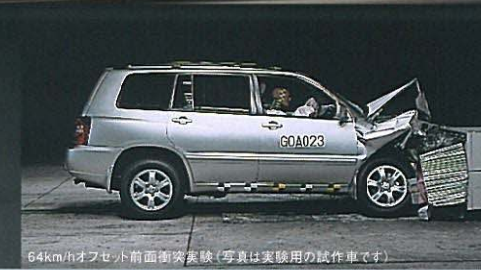
64km/hオフセット前面衝突実験(写真は実験用の試作車です)
