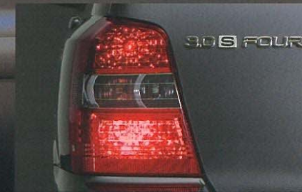
リヤフォグランプ リヤフォグランプを装着した場合、テールランプの点灯状態が変わります。
