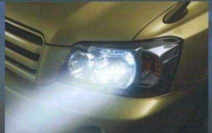
ハイパーワイドディスチャージヘッドランプ ヘッドランプ内の反射面を大きくし光量をアップ(従来比+20%)しました。
