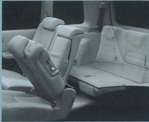
セカンドシートウォークイン機構&サードシートフォールドダウン
