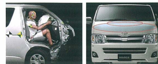
実験用車両でオフセット前面衝突実験
