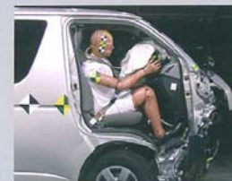
衝突時の衝撃荷重を効率的に分散・吸収して、キャビンの変形を抑制し、客室空間をしっかりと確保します。 ■写真は実験用車両でオフセット前面衝突実験です。
