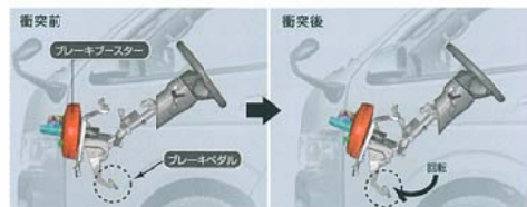
ステアリング&ブレーキペダル後退低減機構(回転式)
