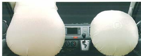
SRSエアバッグ ■写真は機能説明のためにSRSエアバッグが作動した状態を再現したものです。
