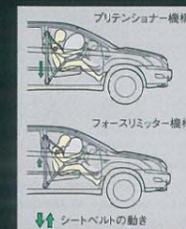
プリテンショナー機構は、万一の衝突時に、シートベルトを瞬時に巻き取ることによって、乗員の拘束効果を高める働きをします。また、フォースリミッター機構は、一定以上の荷重がかかると、その荷重を維持しながらシートベルトを繰り出すことにより、胸部への衝撃を緩和します。
