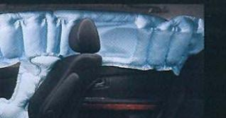
SRSサイドエアバッグ(運転席・助手席)&SRSカーテンシールドエアバッグ(前後席)
