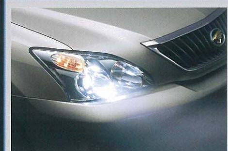
インテリジェントAFS<sup>\*1</sup>(ヘッドランプコントロールシステム)(AIRS、350G・240Gのパッケージ車に標準装備)
