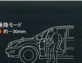
標準車高に対し、車高が約30mm低いモード。クルマへの乗り降りや荷物の積み下しが容易になります。乗降モードは、乗降モードスイッチON状態で、エンジン停止時に作動します。なお、Hiモード時は乗降モード機能は作動しません。
